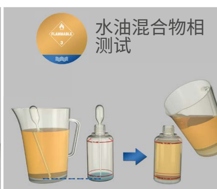
水油混合物相测试 用吸管吸取游离水并放入瓶中。如果水未达到下液面线, 则用来自同一样品的燃料灌至上液面线
