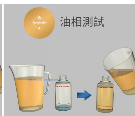
油相測試 如果樣品中看不到游離水，則用燃料將瓶子灌至上液麵線
