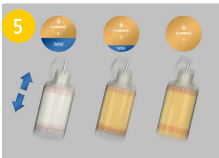
7 Pour tous les types de tests, fermez le bouchon du flacon compte-gouttes et agitez l'échantillon énergiquement pendant 5 secondes
