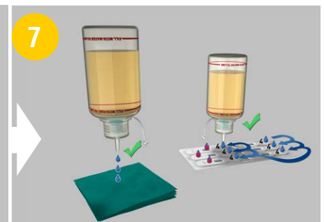
9 Laissez tomber 3 gouttes sur un mouchoir en papier pour dégager le bouchon, puis laissez soigneusement tomber 4 gouttes de fluide bleu sur chaque échantillon tout en veillant à ne pas endommager la fenêtre de visualisation
