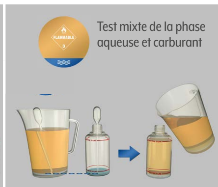
5 Test mixte de la phase aqueuse et carburant Utilisez la pipette pour recueillir l'eau libre et la mettre dans le flacon. Si l'eau n'atteint pas la ligne inférieure, remplissez le flacon de carburant provenant du même échantillon jusqu'à la ligne supérieure
