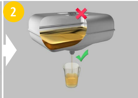
2 Prélevez un échantillon au fond du réservoir
