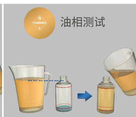
油相测试 如果样品中看不到游离水, 则用燃料将瓶子灌至上液面线
