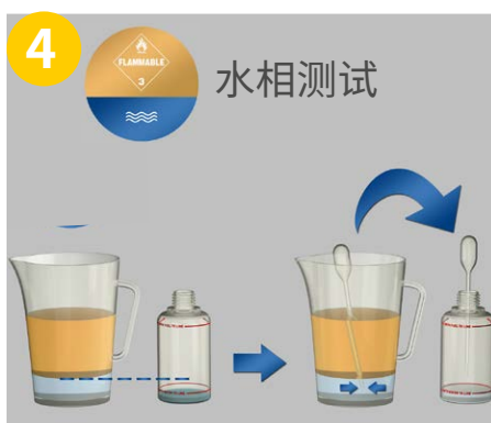
4 水相测试 如果样品中有足够的游离水, 则用吸管将瓶子灌至下液面线
