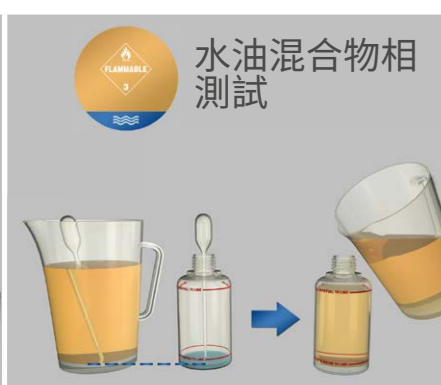
水油混合物相測試 用吸管吸取游離水並放入瓶中。如果水未達到下液麵線，則用來自同一樣品的燃料灌至上液麵線
