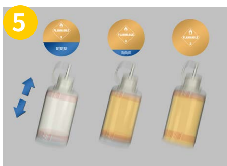
5 對於所有類型的測試，固定滴管蓋，用力搖晃樣品5秒
