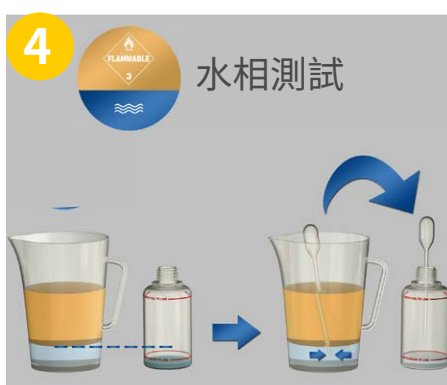
4 水相測試 如果樣品中有足夠的游離水，則用吸管將瓶子灌至下液麵線
