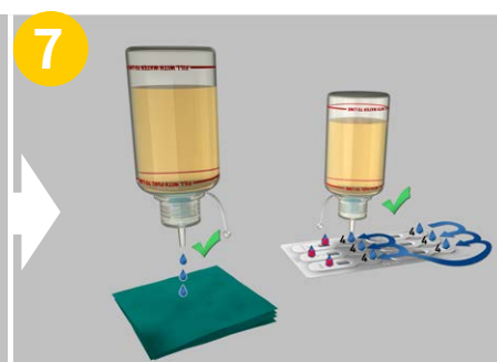
7 將3滴液體滴到紙巾上以清潔滴管，然後小心地將4滴藍色液體滴入每個樣品槽中，確保不會濺到觀察窗
