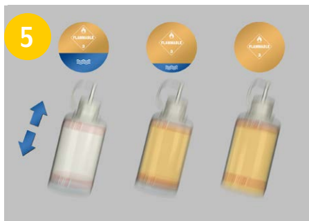
Pour tous les types de tests, fermez le bouchon du flacon compte-gouttes et agitez l'échantillon énergiquement pendant 5 secondes
