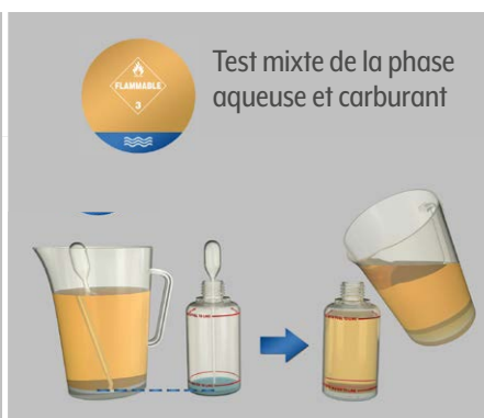
Utilisez la pipette pour recueillir l'eau libre et la mettre dans le flacon. Si l'eau n'atteint pas la ligne inférieure, remplissez le flacon de carburant provenant du même échantillon jusqu'à la ligne supérieure
