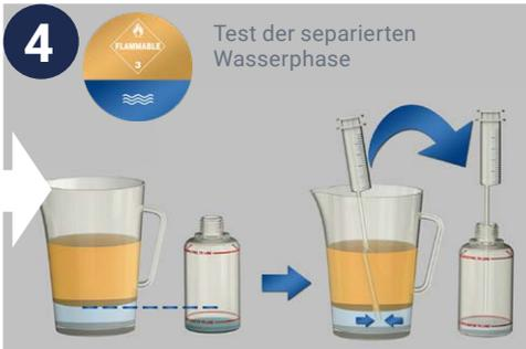
Befindet sich im Probenentnahmebehälter genügend separiertes Wasser, dann nehmen Sie separiertes Wasser mit der Spritze auf und spritzen Sie dieses bis zur unteren Linie mit der Aufschrift „**Wasserlinie**“ in die FUELSTAT®-Testflasche.
