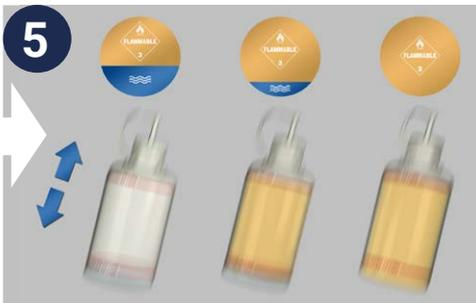
Bei allen Testarten die Tropfverschlusskappe befestigen und die Probenentnahme **5 Sekunden lang kräftig schütteln**.
