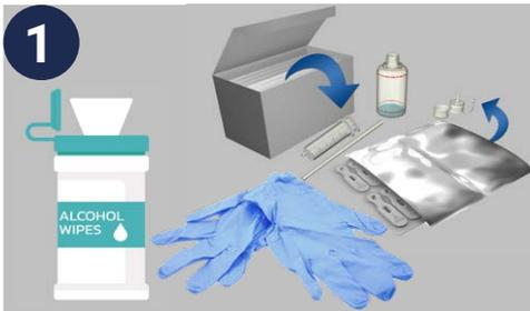
Reinigen Sie die Ausrüstung zur Probenentnahme mit Alkoholtüchern mit einem Alkoholgehalt von 70 % und lassen Sie sie an der Luft trocknen. Halten Sie die FUELSTAT®-Testkit-Inhalte griffbereit. Tragen Sie beim Umgang mit Kraftstoff die richtige PSA, einschließlich Nitrilhandschuhe und Schutzbrille.
