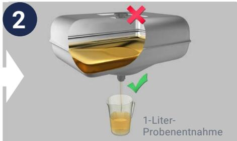
Nehmen Sie eine **1-Liter-Probe** vom tiefsten Punkt des Tanks gemäß den Richtlinien des OEM und der Industrie (siehe Hinweise zur Probenentnahme auf Seite 1).
