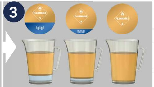
Schütteln Sie die Probenentnahme kräftig mit einer wirbelnden Bewegung und lassen Sie sie **12-15 Minuten lang ruhen**. Hat sich nach dem Absetzen Wasser separiert?
