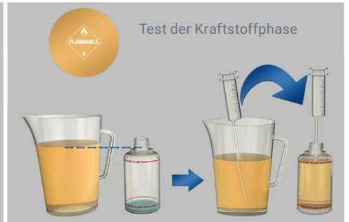
Befindet sich kein sichtbares, separiertes Wasser im Probenentnahmebehälter, dann nehmen Sie den Kraftstoff nahe des Bodens des Probenentnahmebehälters mit der Spritze auf und spritzen ihn bis zur oberen Linie mit der Aufschrift „**Kraftstofflinie**“ in die FUELSTAT®-Testflasche.
