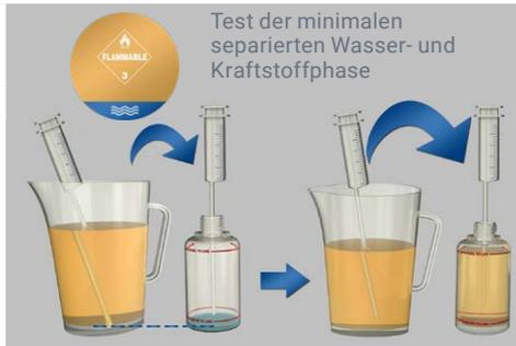
Befindet sich sichtbares, separiertes Wasser im Probenentnahmebehälter, reicht dies jedoch nicht aus, um die Testflasche mit der Spritze bis zur „**Wasserlinie**“ der FUELSTAT®-Testflasche aufzufüllen, dann nehmen Sie Kraftstoff nahe des Bodens des Probenentnahmebehälters auf und füllen ihn bis zur oberen Linie der Testflasche mit der Aufschrift „**Kraftstofflinie**“ ein.
