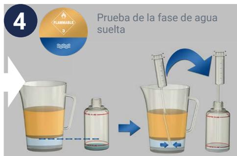
Si hay suficiente agua suelta en la muestra, con la jeringa agregue agua suelta en la botella de prueba FUELSTAT® hasta la línea inferior que está marcada como **"Línea de agua"**
