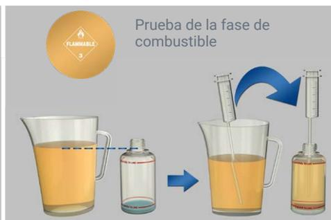
Si no hay agua suelta visible en la muestra, con la jeringa agregue combustible de cerca del fondo de la muestra en la botella de prueba FUELSTAT® hasta la línea superior que está marcada como **"Línea de combustible"**
