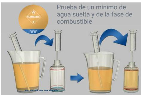
Si hay agua suelta visible pero no suficiente para llegar a la **"línea de agua"** cuando se la inyecta en la botella de prueba FUELSTAT®, continúe agregando con la jeringa combustible de cerca de la parte inferior de la muestra hasta la línea superior que está marcada como **"Línea de combustible"**
