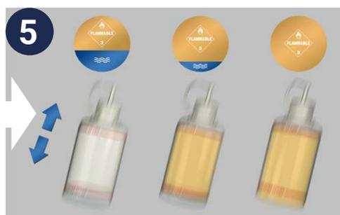
7 Para todos los tipos de test, asegure el tapón con gotero y **agite la muestra enérgicamente durante 5 segundos**
