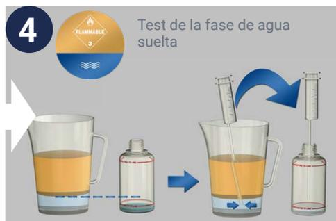
4 Si hay suficiente agua suelta en la muestra, con la jeringa agregue agua suelta en la botella para el test FUELSTAT® hasta la línea inferior que está marcada como **"Línea de agua"**
