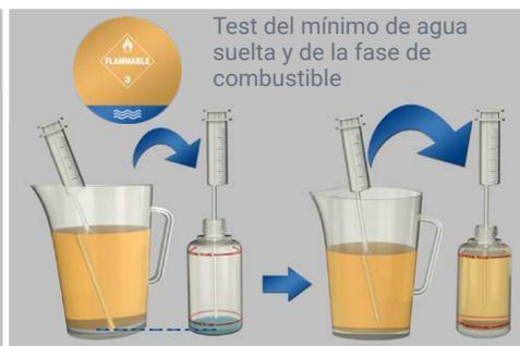
5 Si hay agua suelta visible pero no suficiente para llegar a la **"línea de agua"** cuando se la inyecta en la botella para el test FUELSTAT®, continúe agregando con la jeringa combustible de cerca de la parte inferior de la muestra hasta la línea superior que está marcada como **"Línea de combustible"**
