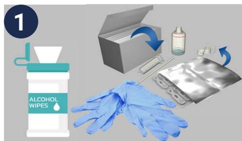
1 Limpie el equipo de muestreo usando paños con alcohol al 70% y deje secar. Tenga a mano el contenido del kit del test FUELSTAT®. Cuando manipule combustible lleve el EPI correcto, incluidos guantes de nitrilo y gafas de seguridad.
