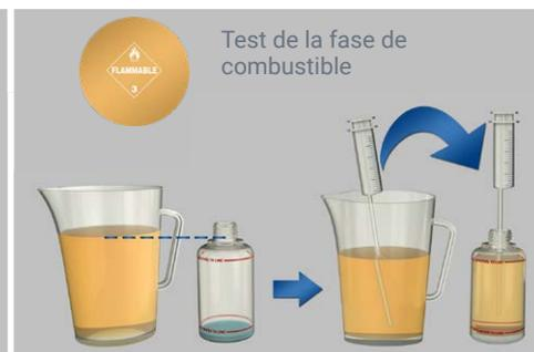
6 Si no hay agua suelta visible en la muestra, con la jeringa agregue combustible de cerca del fondo de la muestra en la botella para el test FUELSTAT® hasta la línea superior que está marcada como **"Línea de combustible"**
