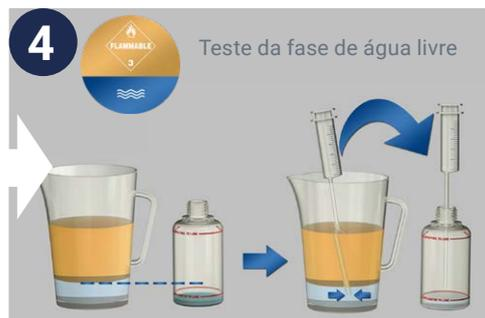
4 Se houver suficiente água livre na amostra, use a seringa para aplicar água livre no frasco de teste FUELSTAT® até a linha inferior, com a indicação "Linha de água"
