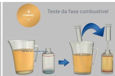
6 Se não houver água livre na amostra, insira combustível coletado próximo ao fundo da amostra no frasco de teste FUELSTAT® até alcançar a linha de cima "Linha de combustível".
