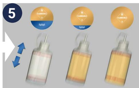
7 Em todos os testes, segure firme a tampa do conta-gotas e **agite bem a amostra durante 5 segundos**.
