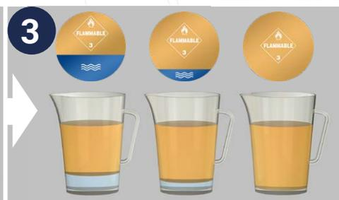
3 Agite a amostra com um movimento circular e deixe **repousar entre 12 e 15 minutos**. Depois de repousada, observe se há água livre.
