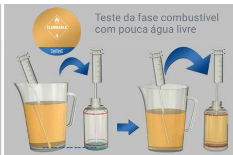
5 Se houver água livre, mas não o suficiente para alcançar a indicação "Linha de água" do frasco de teste FUELSTAT®, insira combustível coletado próximo ao fundo da amostra até alcançar a linha de cima "Linha de combustível".
