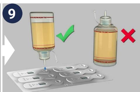
11 Mantenha o frasco inclinado caso sejam necessárias gotas adicionais. Se o frasco for virado para cima em qualquer etapa deste processo, é importante retornar à etapa 5.
